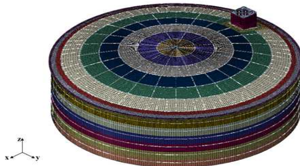
그림 36 내조 기본설계안의 유한요소 모델
