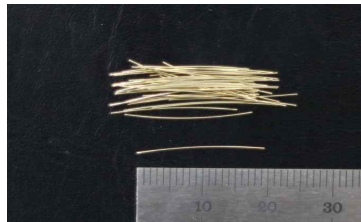
그림 104. 직선형 강섬유 ( \phi = 0.2 mm, L = 19.5 mm)
