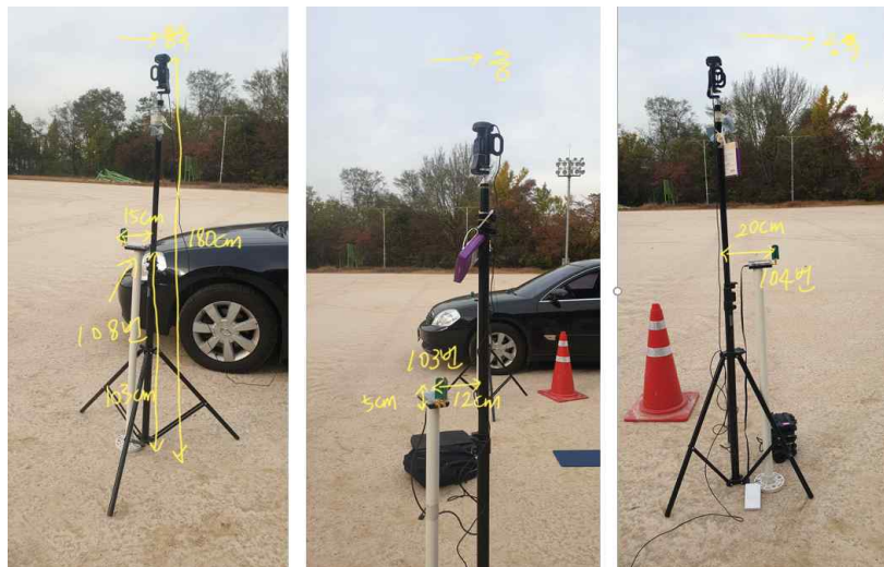
그림 59. UWB 거리 측정 센서(P440)와 GNSS 수신기(삼각대 위에 위치)
