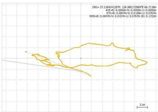
그림 62. UWB ID 104번에 해당하는 GNSS 수신기 post processing 결과
