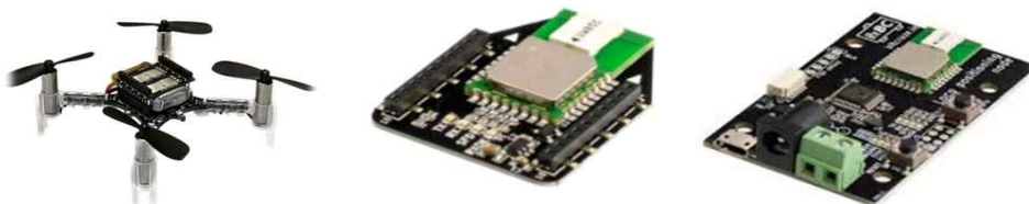
그림 46. Crazyflie 2.0과 UWB 거리측정 센서인 LPS deck & Node
