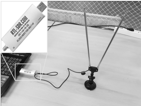
그림 1. 실험에 사용된 RTL-SDR dongle.
