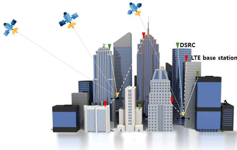
그림 68. 도심지역 LTE 기지국에 DSRC 송수신기를 보강 배치하여 구성한 측위 네트워크 개념도
