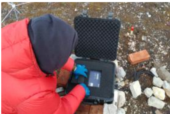
<그림 22> 지반온도 계측기 설치
