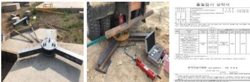
Fig. 4.2 변위 대응형 플랜트 시험체의 하중재하 실험
