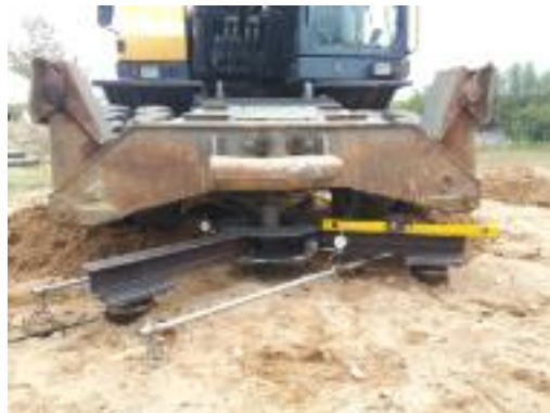
<그림 69>. 신형식 기초 3지점 재하시험
