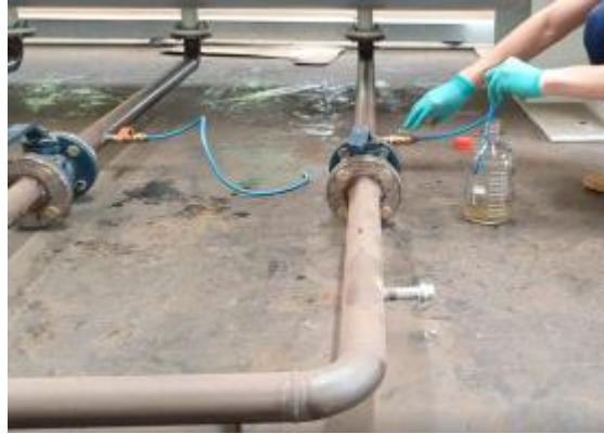
그림 3.5.18. Mixture sampling process at water outlet.
