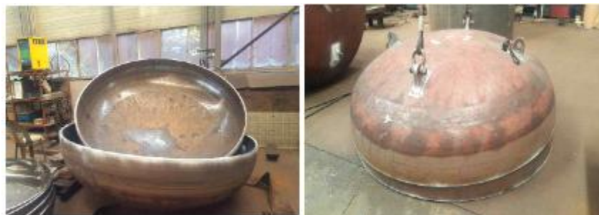
그림 3.5.14 Production of actual experimental vessel head
