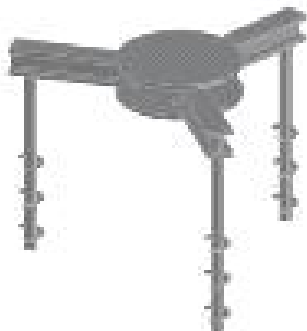
(a) 단위 신형식 기초(군말뚝 형식) 예시 (b) 모듈 플랜트 신형식 기초 적용 예시
