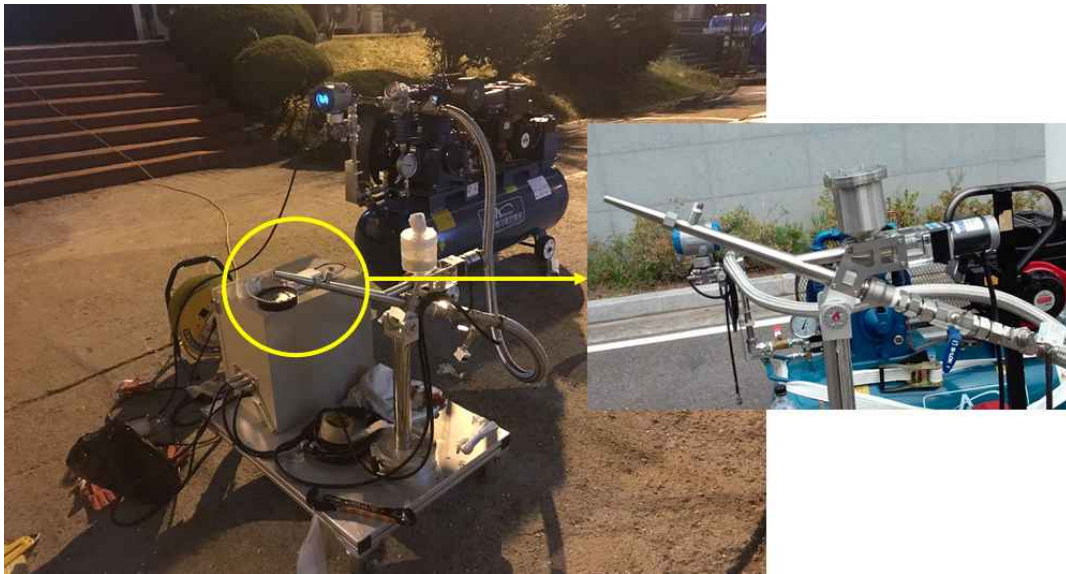
그림 21. SCD 방사 노즐 시스템
