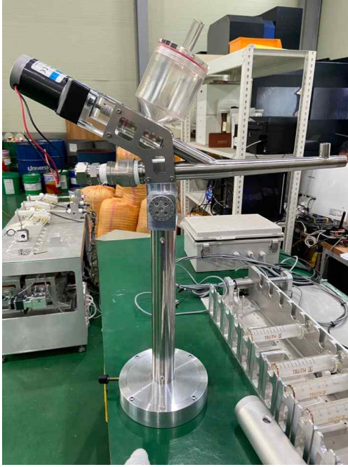
그림 20. SCD 방사 노즐(좌) 사진 및 제원(우)
