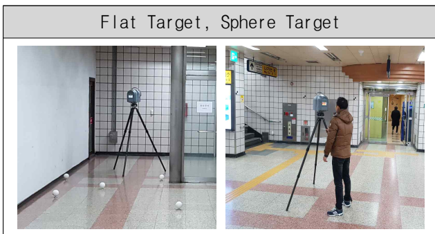
그림 2-15. 정합 및 좌표계획을 위한 Target
