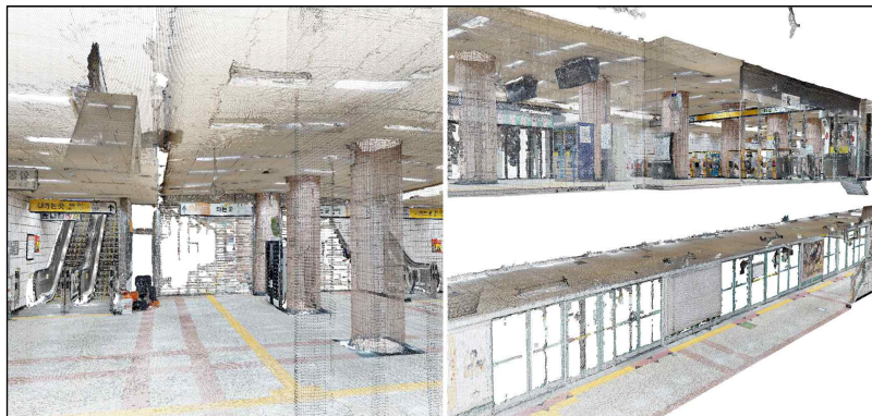
그림 2-19. 3D 캡처를 통한 포인트 클라우드 추출
