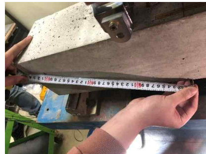
(c) 균열 탐지 거리 약 310mm
