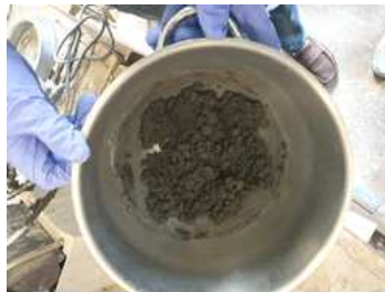
양생 전 CNT/Cement 복합체
