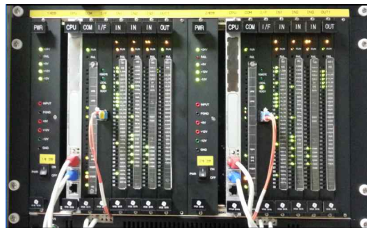
[그림 1-7] 역제어장치 전체 구성도 및 논리부 실장 구성 (대기 2중계)
