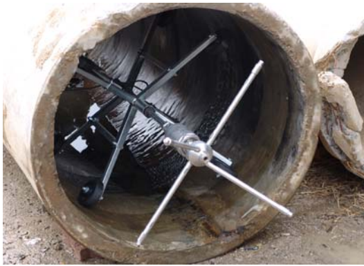
<개발된 회전형 Hydro-demolition 및 환경에 따른 회전노즐 종류>
