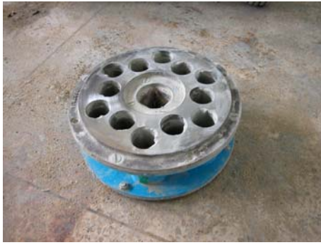
실험용 토출사이즈(32mm×120mm, 0.7m³/hr)
