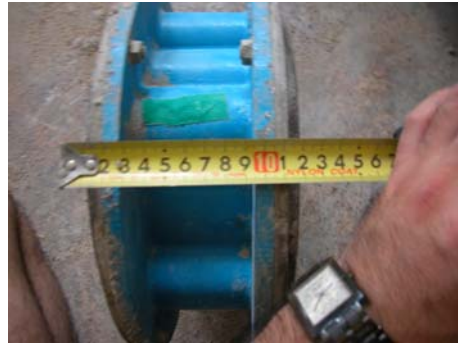
실험용 토출사이즈(32mm×120mm, 0.7m³/hr)
