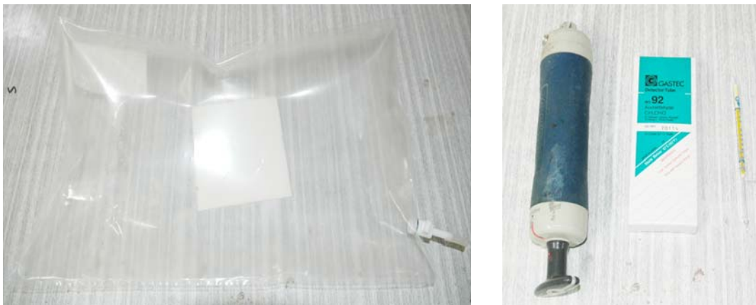
Fig. 3-43. 시험편과 시험가스를 넣은 가스백(좌), 가스 검지관 및 측정도구(우)
