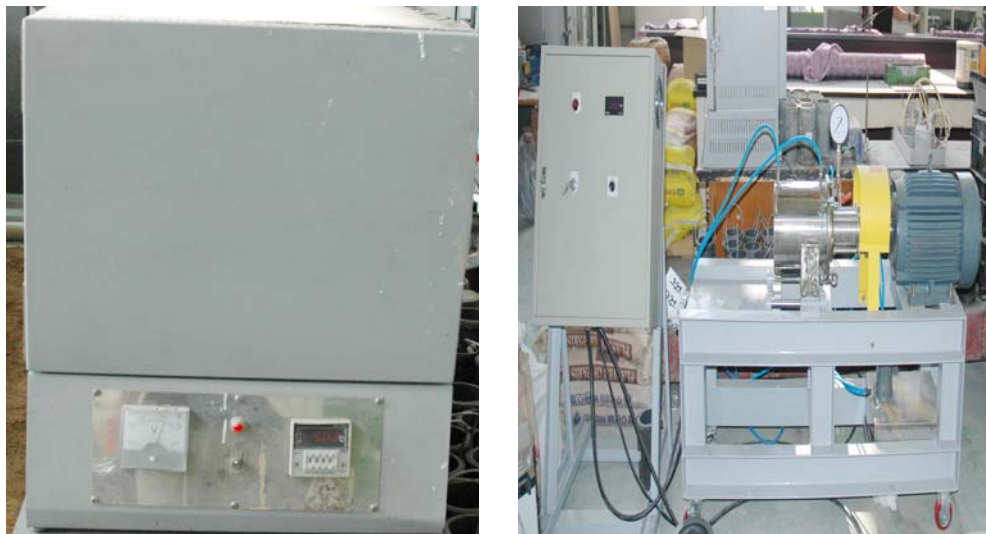
Fig. 3-16. 광촉매 제조에 사용된 고온가열기(좌) 및 어트리션밀(우)
