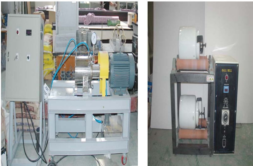
Fig. 3-25. 광촉매 제조에 사용된 어트리션밀(좌) 및 볼밀(우)
