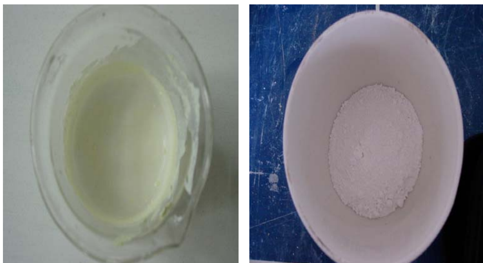
Fig. 3-17. 황을 치환한 이산화티탄의 소성전(좌) 및 소성후(우)
