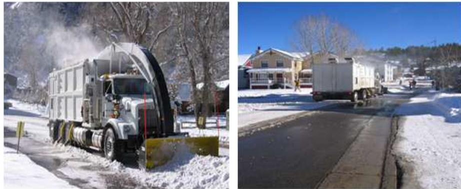
〈그림 2-4〉 R&D로 개발 중인 이동식 제설장비 (용해로 장착, 미국, 2007~현재)
