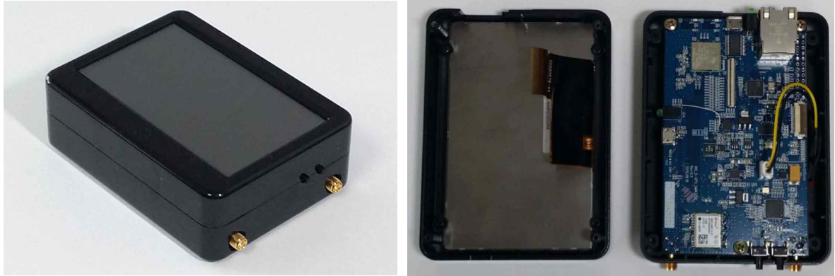
그림 93. 단말기 시작품 외형 및 내부
