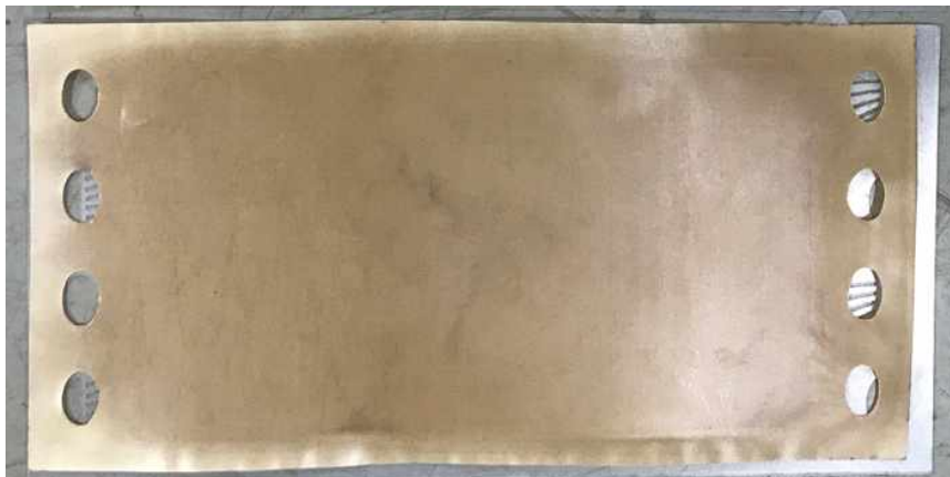
[그림 43] 이동형 전기투석 장치용 음이온정류막 시제품 사진
