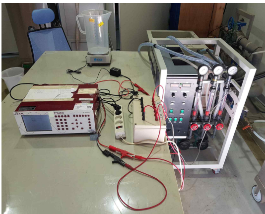
[그림 54] 소비전력 측정 장면
