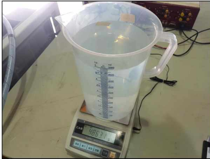
[그림 56] 담수 용액 무게 측정 장면
