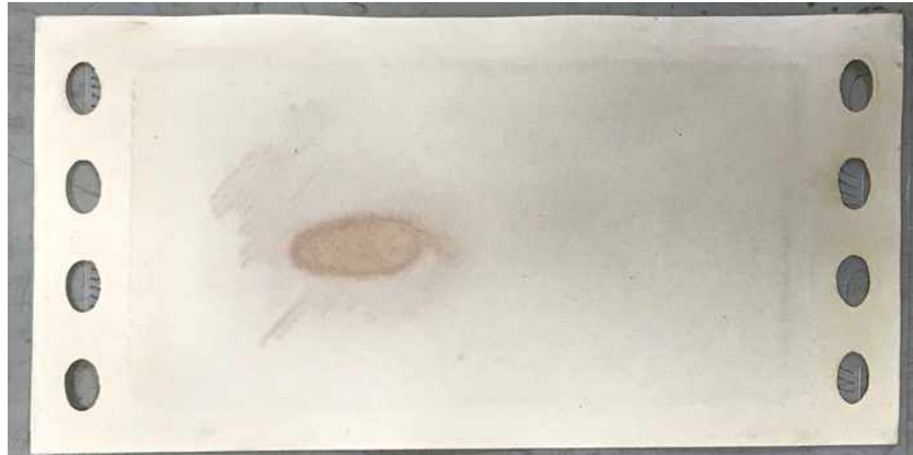
[그림 42] 이동형 전기투석 장치용 양이온정류막 시제품 사진
