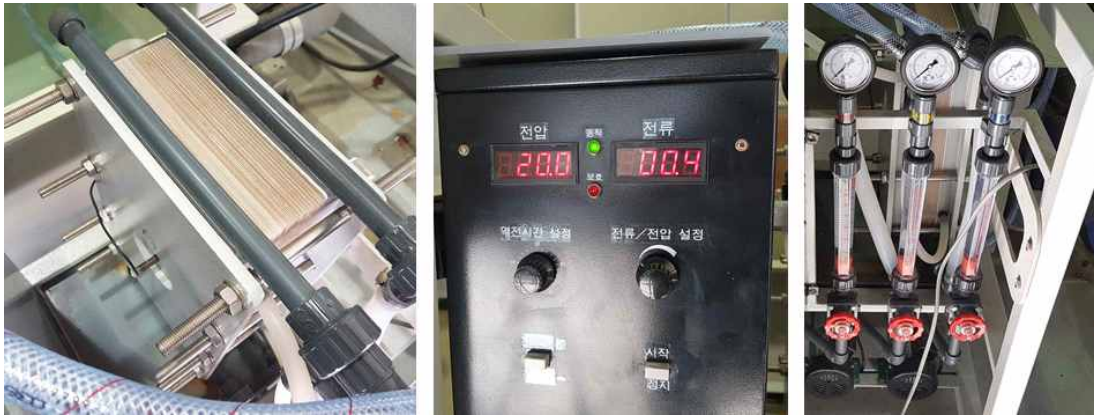
[그림 61] 전기투석 장치의 각 구성 모습, (좌) 전기투석 스택, (중앙) 전기투석 시스템, (우) 유량계 및 펌프
