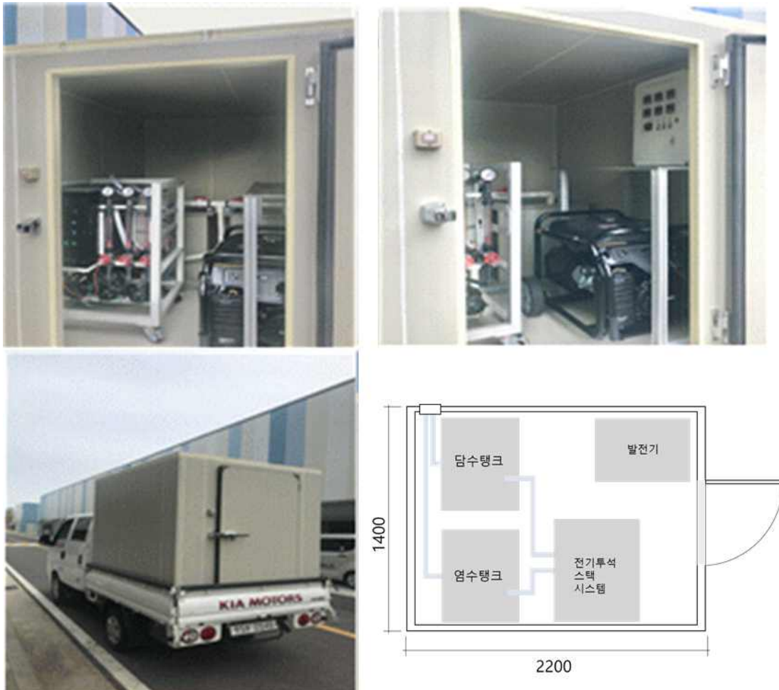
[그림 62] 차량에 탑재하여 이동형 전기투석 담수화 장치를 완성한 모습
