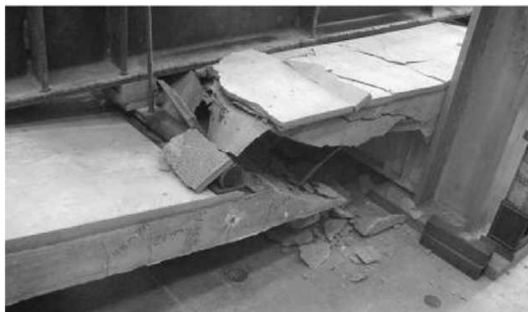
그림 20. FRP-UHPC로 복합 보강된 휨 부재의 전단 파괴
