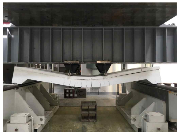
(b) 경량 콘크리트로 보강
