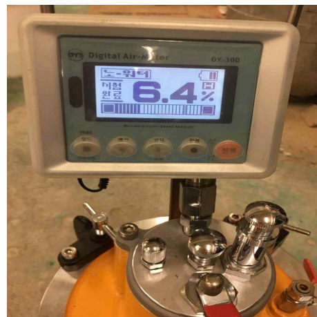
(b) 공기량 측정 시험
