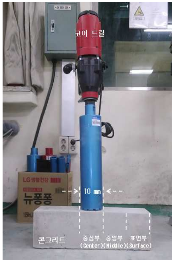
< 그림 3.10 콘크리트 시편 코어 샘플 채취 전경 >
