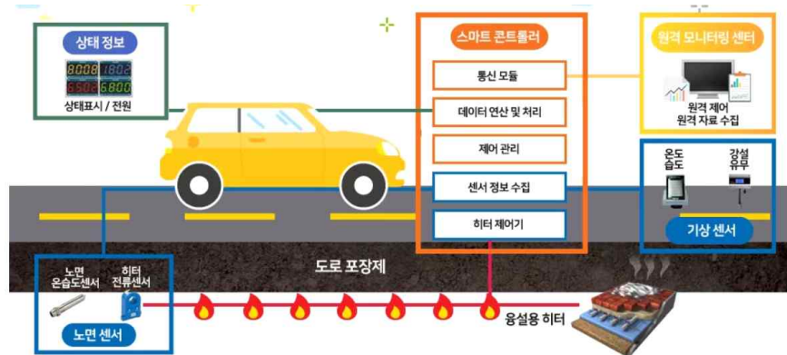
<도로응설 시스템의 일반적인 시스템 구성>
