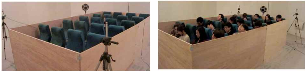
그림21. KTX 일반석 의자 흡음률 측정
