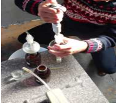
① 암모니아 흡착을 위한 용매 투입
