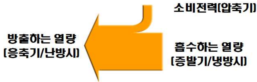
[그림 1.1.11] 히트펌프 시스템의 원리
