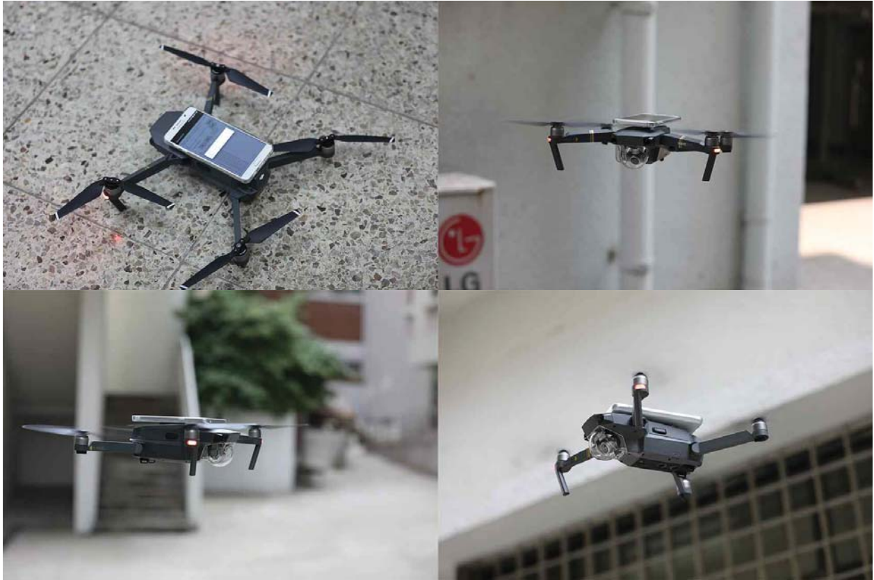
[그림 3.9] 스마트폰을 탑재한 드론의 비행 모습; 기체이외에 장치를 부착하고도 자세를 제어하며 비행할 수 있다.
