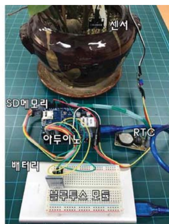
[그림 3.5] 아두이노를 이용하여 계측 시스템을 구성한 모습
