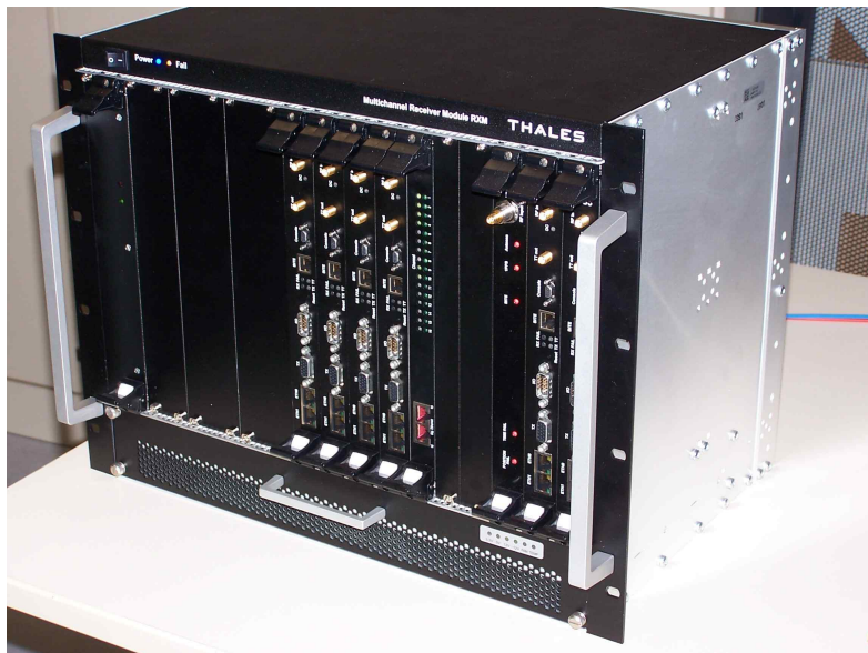
그림 9.1.2 ADS-B 다중채널 수신기의 예 (탈레스社の AS685)
