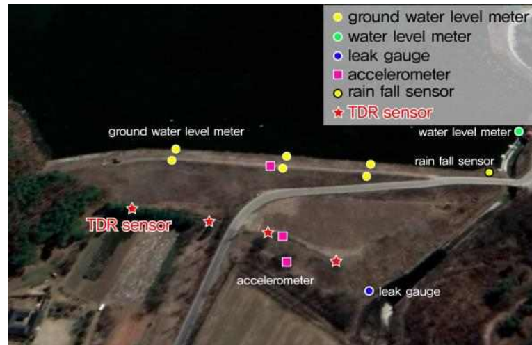
[그림] TDR 센서를 활용한 누수계측 시스템 방안
