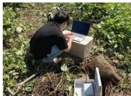
⑩ TDR 센서 계측 테스트
