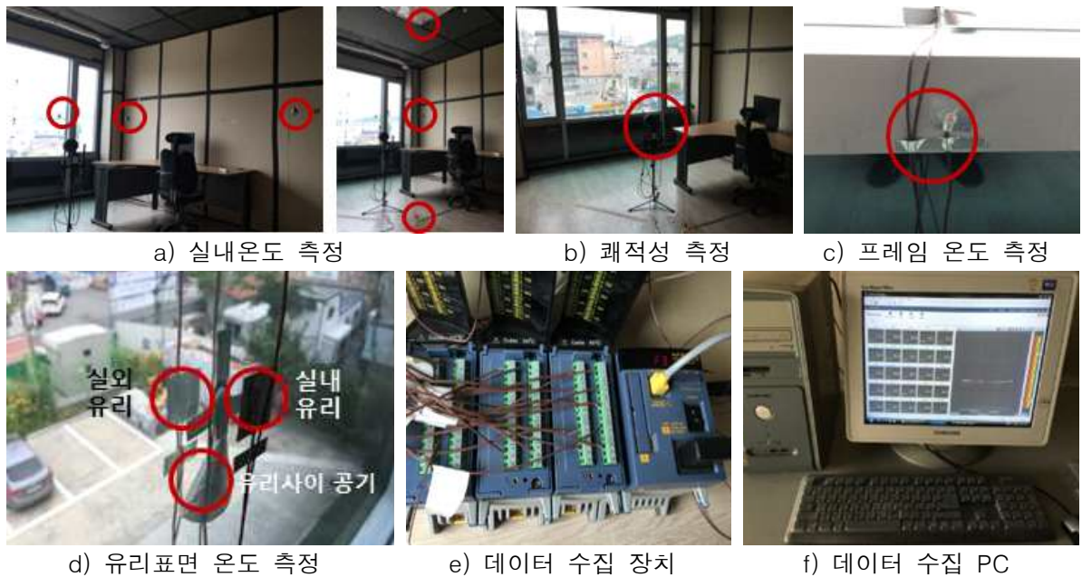
<그림 3-37> 온도 측정 센서 및 데이터 수집 장치
