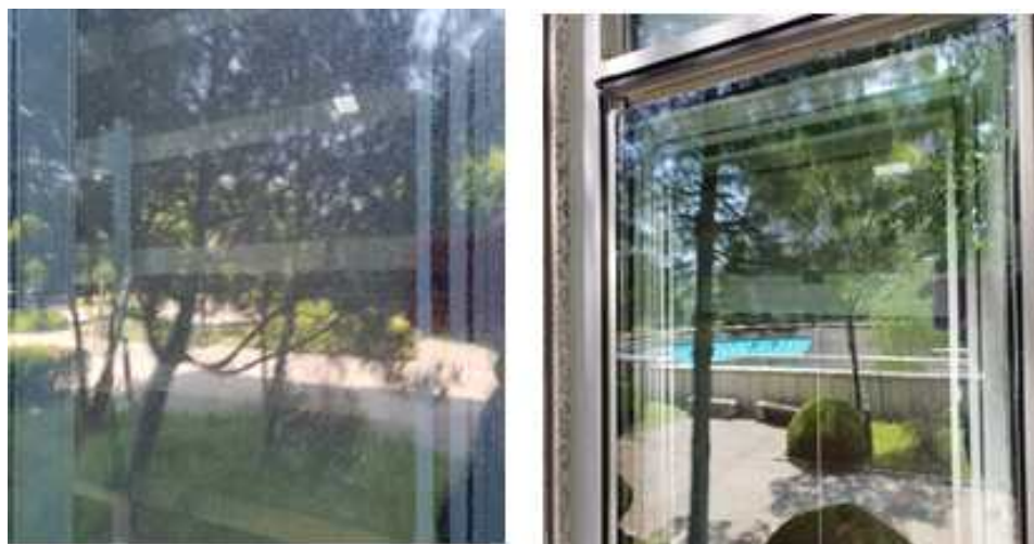
<그림 3-102> 유지관리틀 성능평가(좌: 세척 전, 우: 세척 후)
