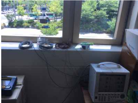
1) 창호 유리온도 측정
