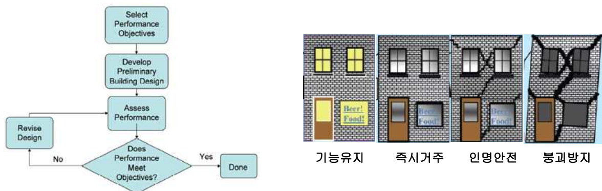
[그림 2.6] 성능기반 내진설계의 절차 및 성능수준 정의
