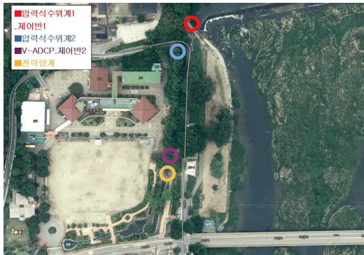
그림 83. 읍내보 V-ADCP, 수위계 시스템 설치
