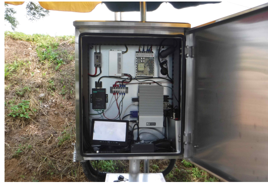
그림 83. 읍내보 V-ADCP, 수위계 시스템 설치
