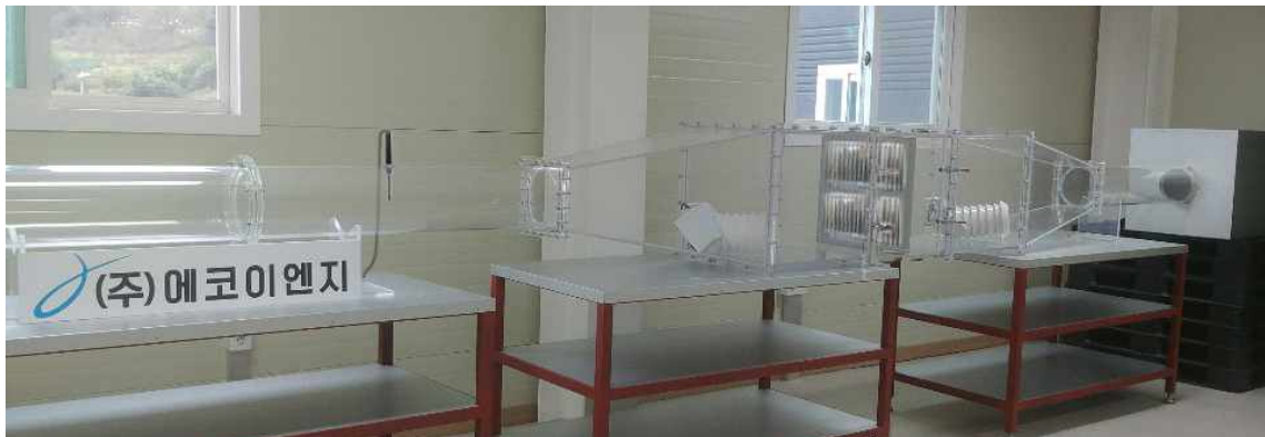
[그림 2-20] 관성충돌 집진판 시험 사진
