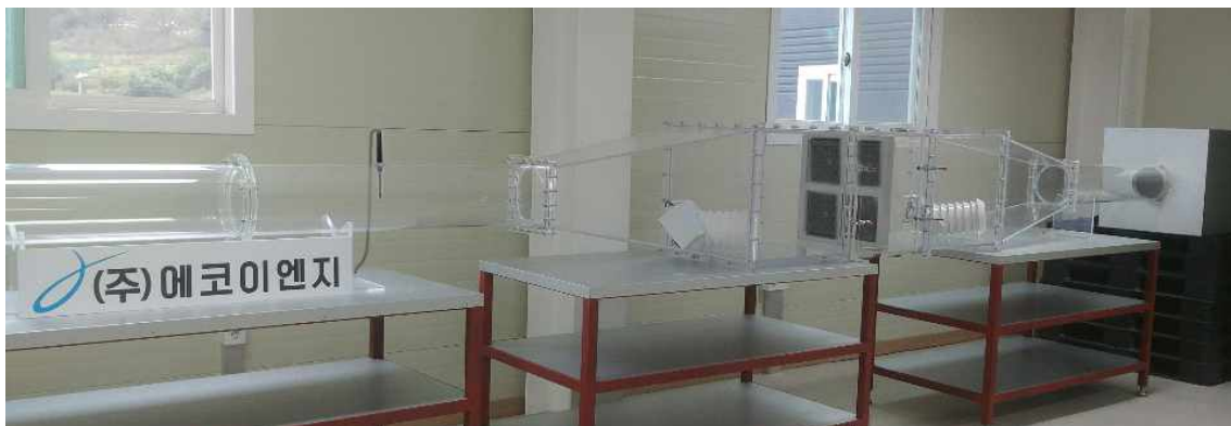
[그림 2-24] 전기집진기 시험 사진
