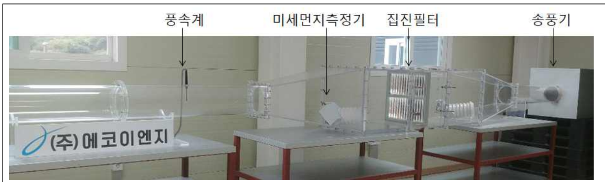
[그림 2-14] 필터유닛 시험 장치 제작
