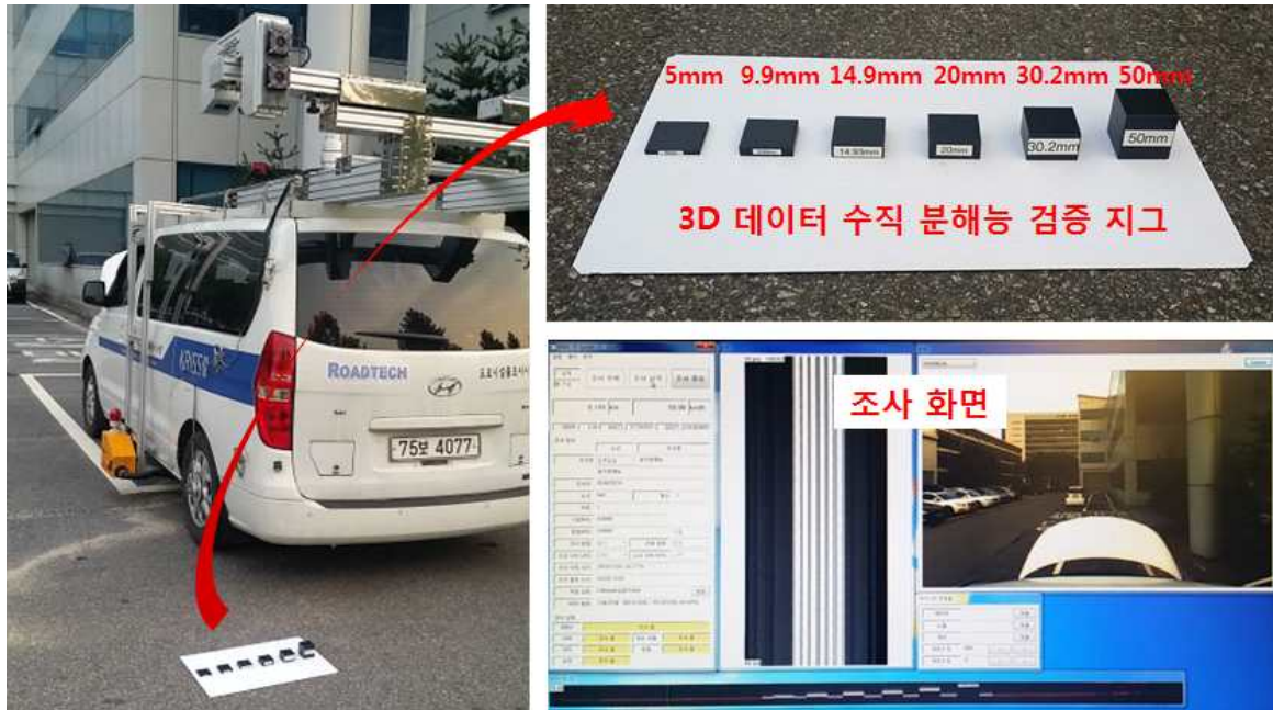
그림 3.34 차선도색 두께 측정 정확도 검증
