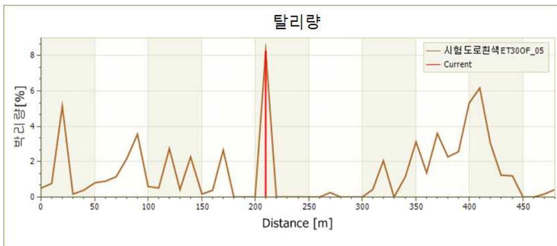
그림 3.45 차선 탈리량 측정 결과
