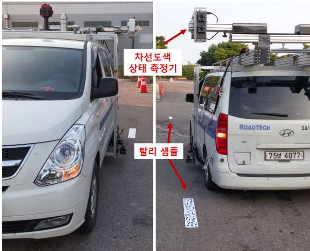
그림 3.40 탈리량 정확도 테스트
