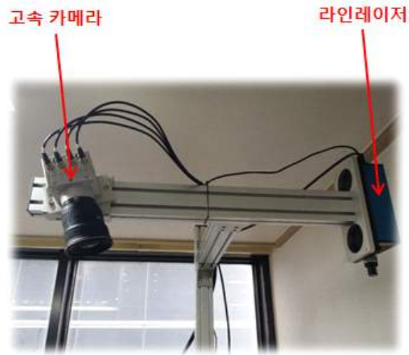
그림 3.12 카메라와 라인레이저로 구성된 3차원 레이저 변위측정기
