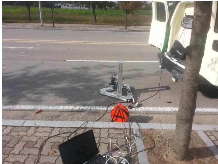
그림 3.54 광학필터의 외부광원 차단효과 시험
