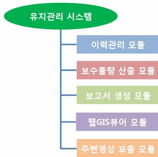
그림 3.79 Stand-alone 시스템 구성
