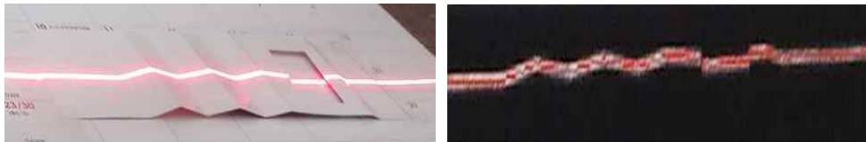
그림 3.13 고속 카메라로 촬영된 레이저라인
