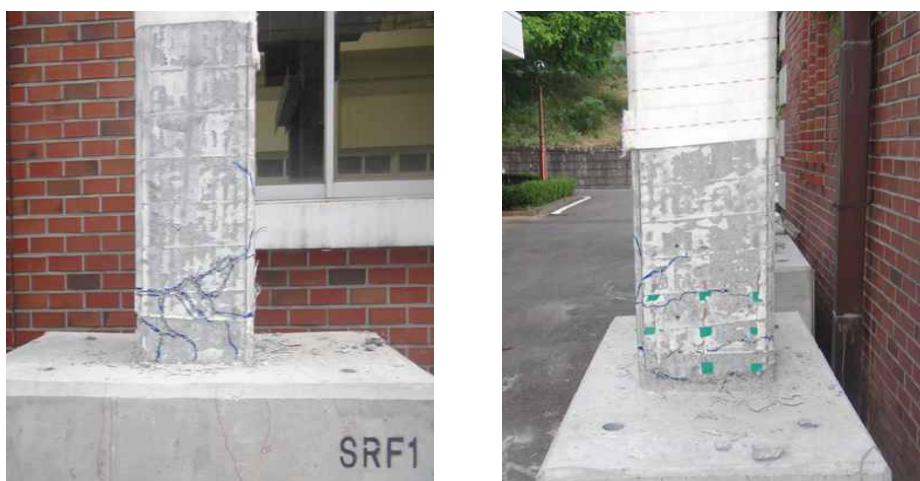
<그림 3.155> 실험 후 보강재 제거 후 크랙 확인
