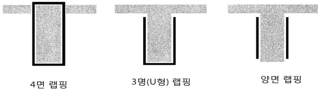
<그림 3.180> FRP를 이용한 전단보강의 랩핑 방법
