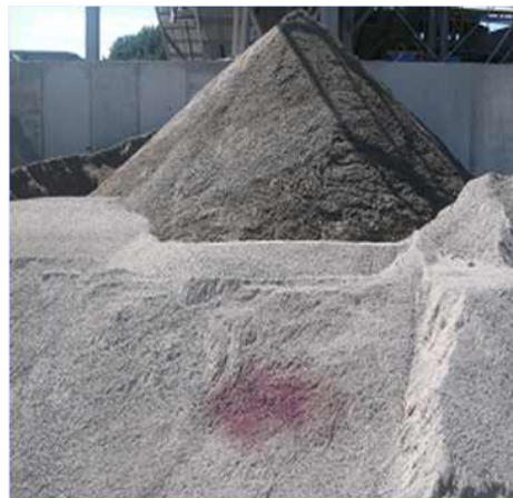
[그림 1] 순환골재의 페놀프탈레인 시험결과
