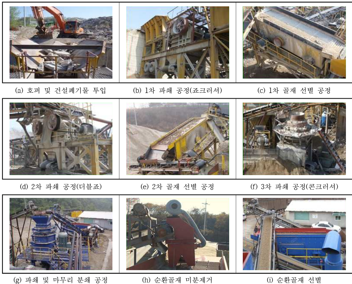
[그림 7] 순환골재 생산시스템 부분과정 상세
