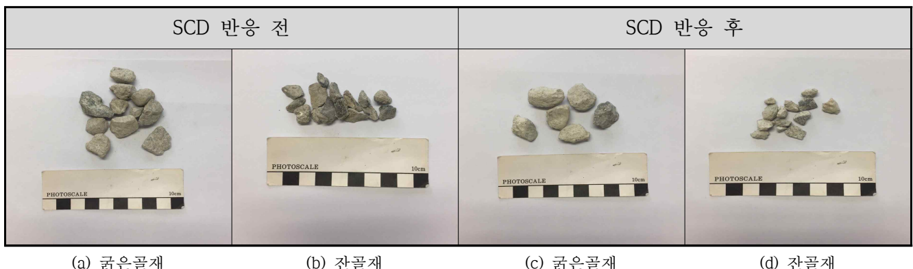
[그림 32] 대형 칼럼실험에 사용한 두 종류의 순환 골재 사진
