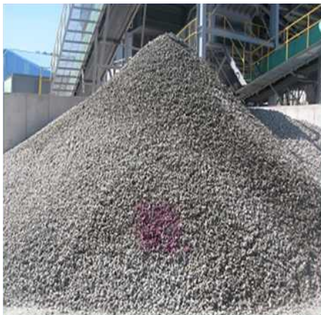
[그림 1] 순환골재의 페놀프탈레인 시험결과
