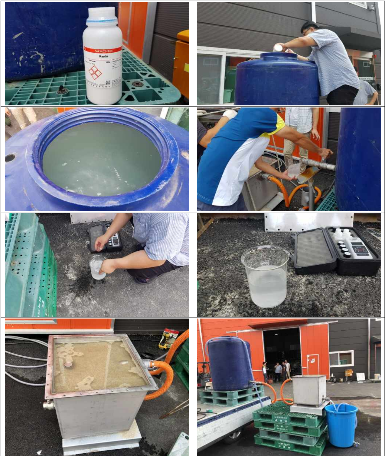
〈그림 3-71〉 부유물질 저감 전처리 취수시설 시제품 수질 시험
