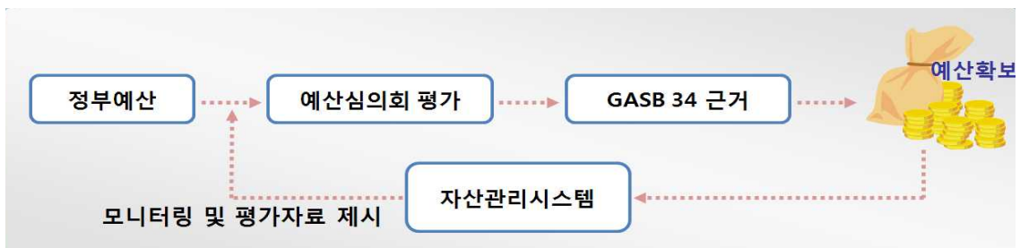
그림 2.49 자산관리 시스템을 통한 시설물 유지관리 예산 배분 과정
