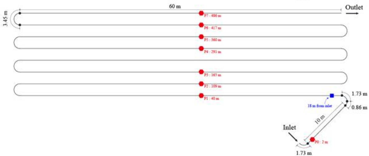
[그림 2.11] 콘크리트 펌핑 실험에 사용한 파이프라인의 개략도
