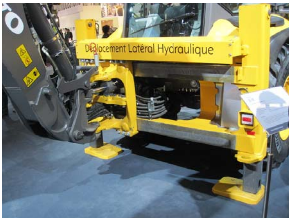
그림 20. 유압을 이용한 지가(지지대) 장치
