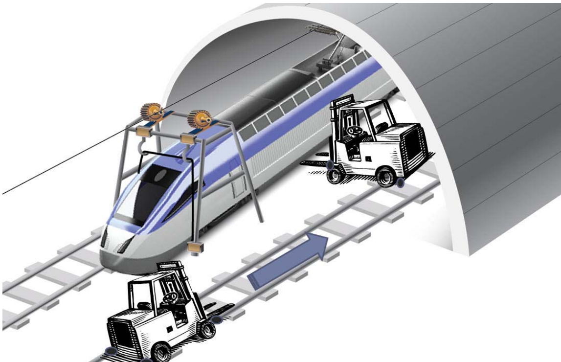
그림 98. 탈선차량의 복구장비 운영에 대한 개념도
