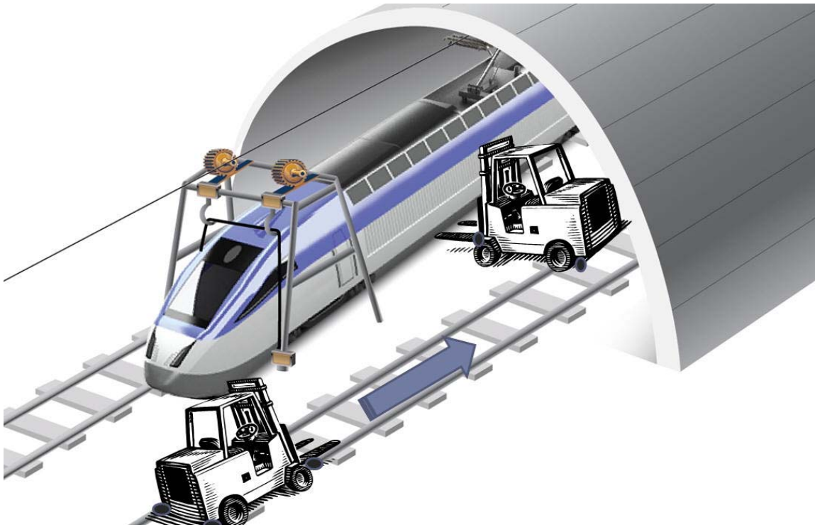
그림 탈선차량의 복구장비 운영에 대한 개념도
