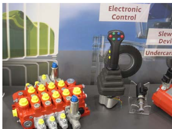
그림 17. 유압제어 밸브 및 제어장치
