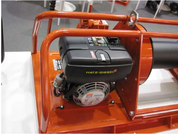
그림 18. 유압장비의 동력발생 장치
