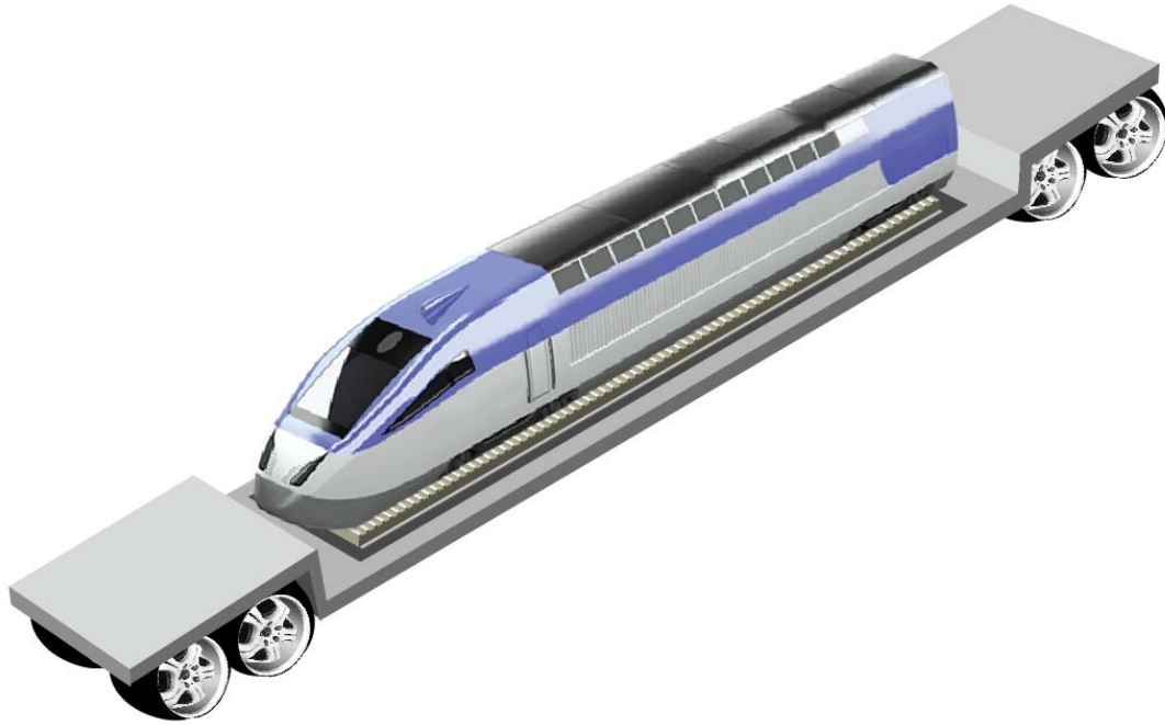
그림 99. 충돌로 인해 파손된 차량의 임시이동을 위한 임시 이동차량 개념도
