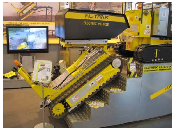
그림 21. 중량물의 계단 등의 이동장치
