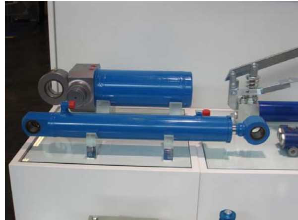
그림 19. 유압장치의 실린더 및 연결장치
