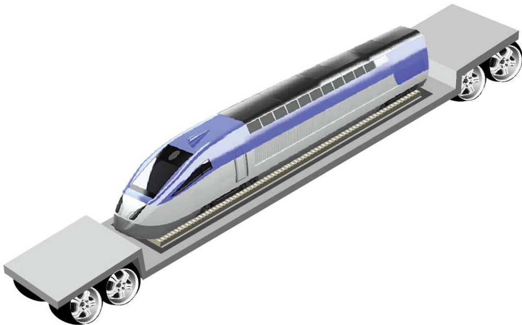
그림 충돌로 인해 파손된 차량의 임시이동을 위한 임시 이동차량 개념도
