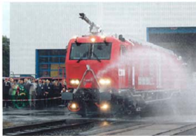
그림 47. 탱크 소방차량, 자가 방호 노즐이 구동되는 모습
