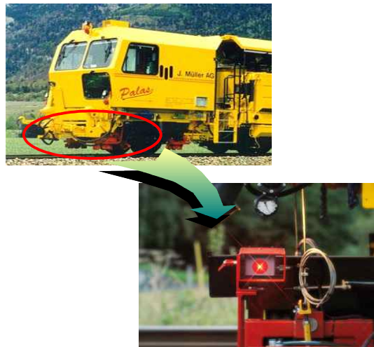
<그림 2-52> 보수차량에 장착된 측정시스템
