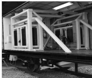
<그림 2-45> RSMV의 측정 장치(철제 우리 안의 측정 차축 위에 위치한 수직으로 움직이는 추)
