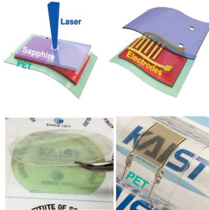
<그림 2-4> (a) PZT 압전 에너지 하베스팅 소자의 Laser Lift Off공정. (b) LLO공정으로 떼어낸 사파이어 기판. (c) 완성형 소자
