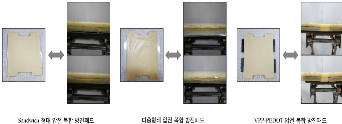
<그림 3-15> 압전소재 방진패드 내구성(박리) 측정
