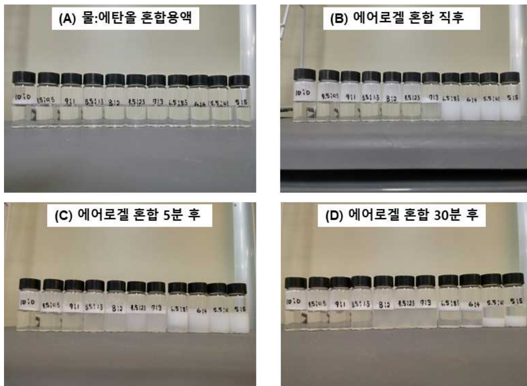
그림 7. 물과 에탄올 비율에 따른 에어로겔의 혼합 변화
