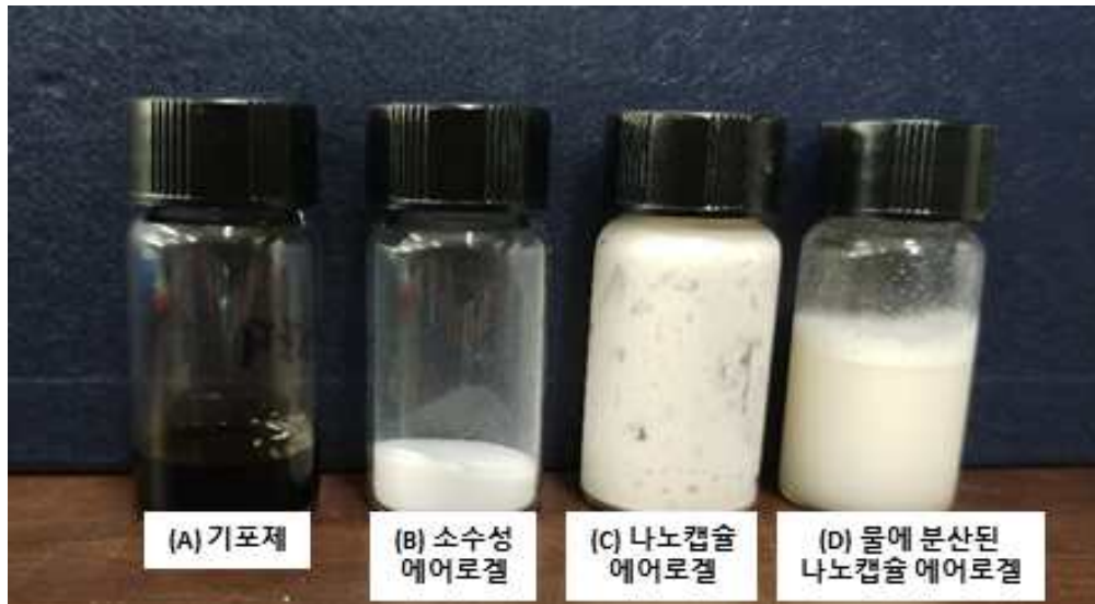
그림 13. 나노캡슐 에어로겔의 소재 및 에멀전 형태, 물에 분산상태의 이미지
