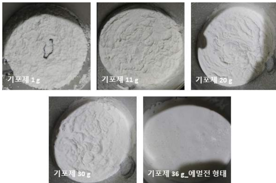
그림 11. 기포제 양에 따른 나노캡슐 에어로겔의 혼합형태
