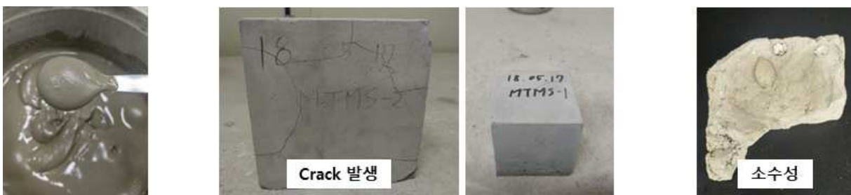
그림 17. MTMS 혼입 콘크리트 실험 사진
