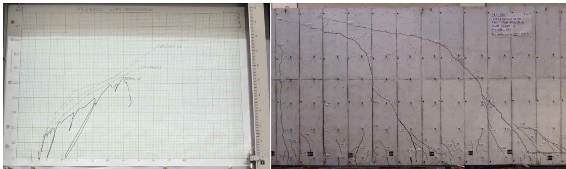
그림 36 (a) 하중 - 처짐 실험 결과 (b) 균열 발생 모습
