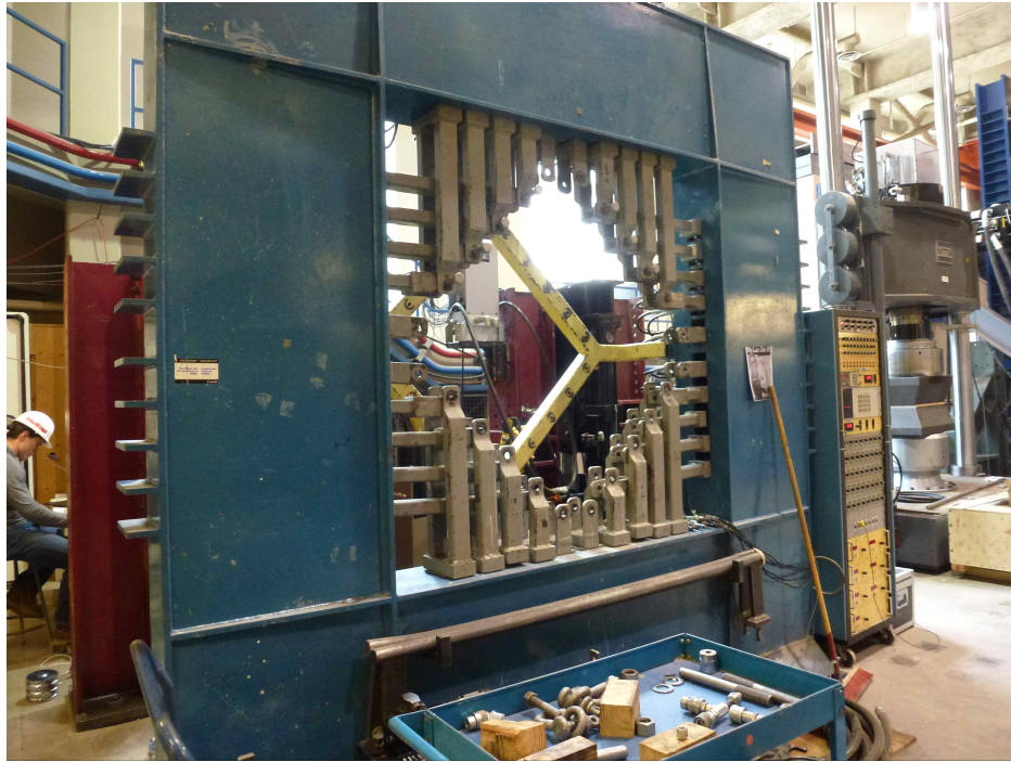
그림 2 철근콘크리트 부재의 전단실험 장비
