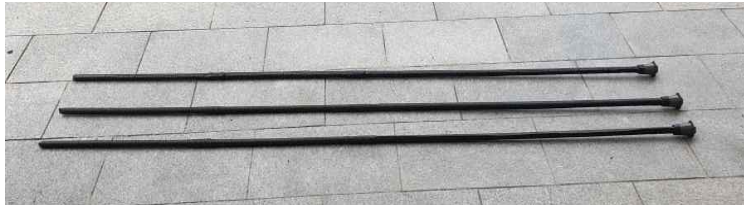
그림 2.51 GFRP strain sensor
