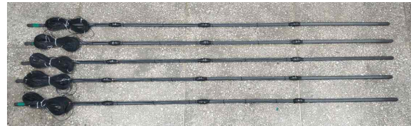
그림 2.9 Steel bar strain sensor
