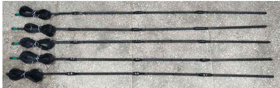
그림 2.8 GFRP strain sensor
