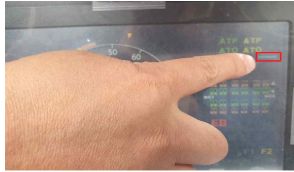
신호장치 DMI 화면에서 이동권한 및 정위치정차 표시 확인
