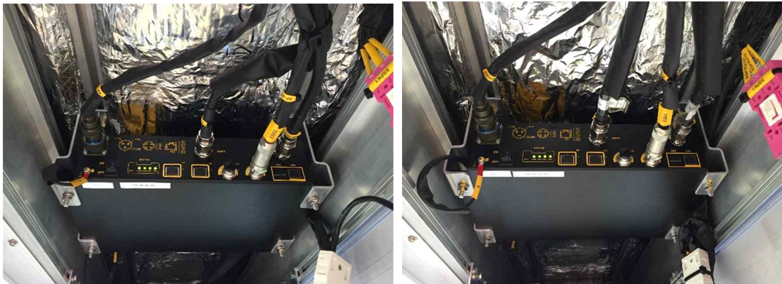
시험차량 차상무선장치(MC1, MC2차량) 동작상태 확인
