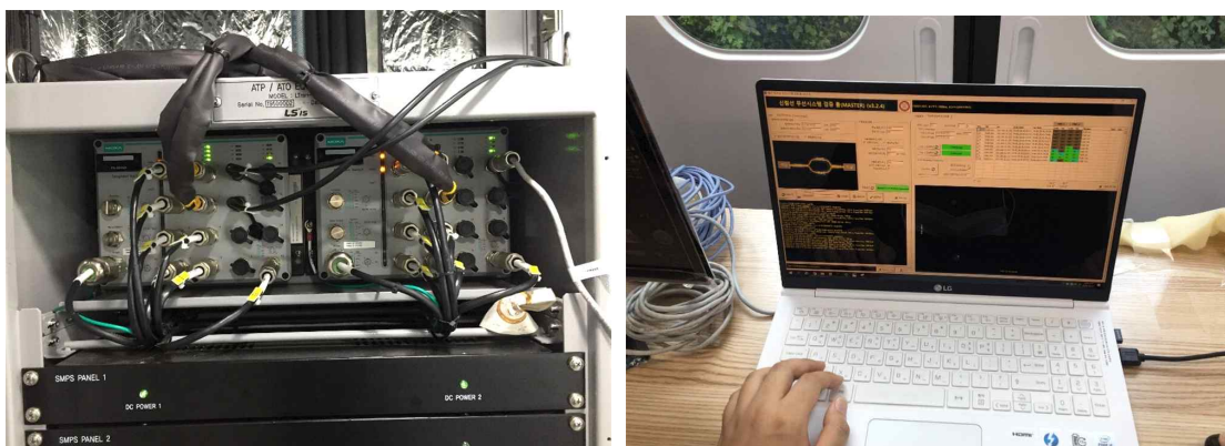
시험차량 차상무선장치 지원주파수 통신 검증시험 진행(M차량 차상 L2스위치 연동)
