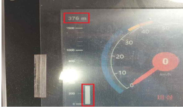
신호장치 DMI 화면에서 이동권한 및 정위치정차 표시 확인
