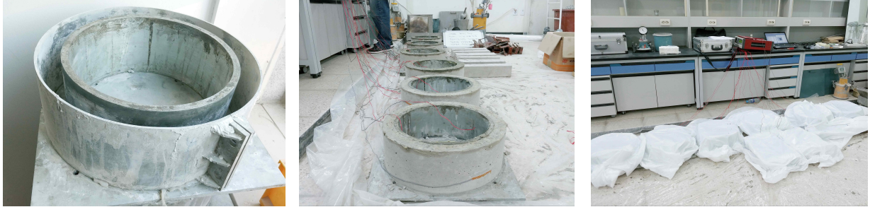
[그림 2-8-5] 건조수축 및 균열 특성 실험 전경
