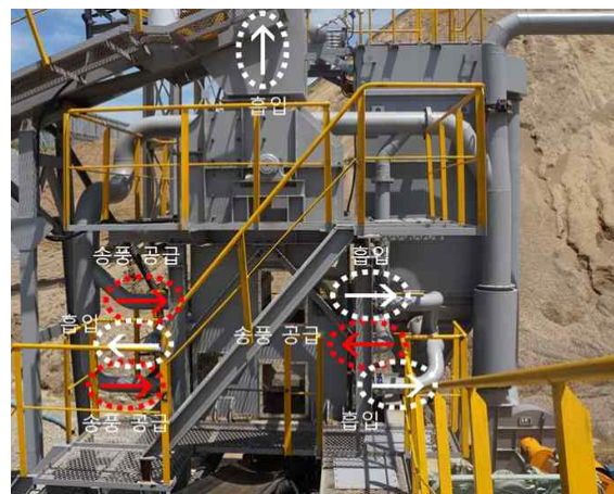
[그림 2-4-3] 송풍의 공급 및 흡입 방향
