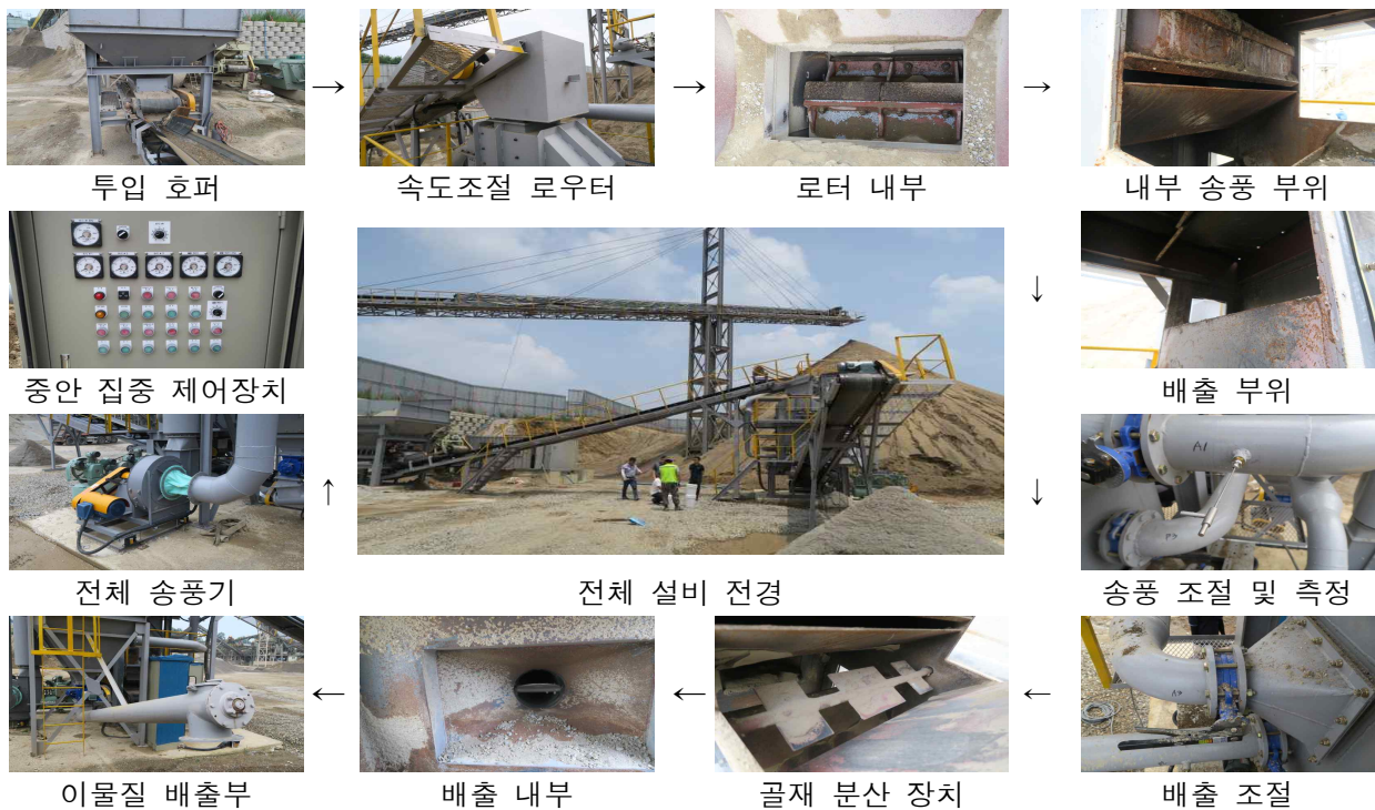
[그림 2-4-1] 생산시스템의 공정도 및 공정사진
