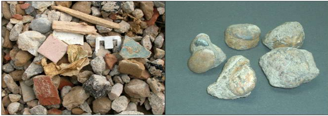
[그림 2-11-1] 순환골재에 포함된 이물질 및 부착 모르타르
