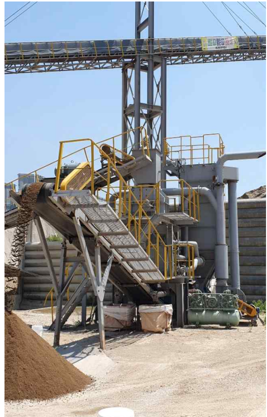
[그림 2-5-1] 고품질 순환골재 및 순환토사 생산 설비에 대한 신기술 인증 및 설치 현황
