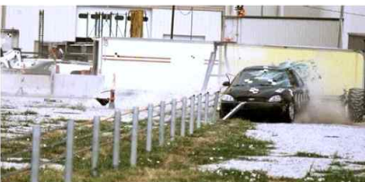
그림 3.29 실물 차량 충돌시험과 컴퓨터 시뮬레이션의 충돌 후 차량 거동
