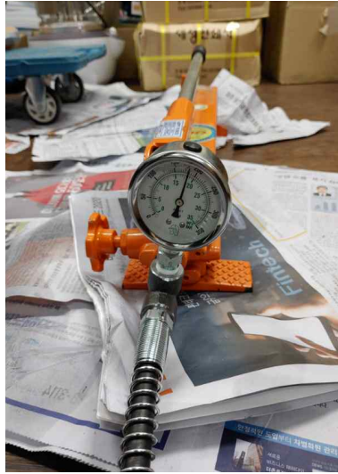
[Type I - SP 보강재 프리스트레스 힘 도입 장치 시제품]
