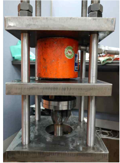
[Type I - SP 보강재 프리스트레스 힘 도입 장치 시제품]
