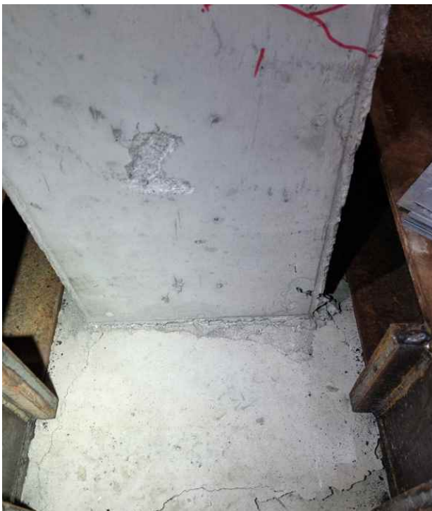
[그림 2.20] SP 보강재가 적용된 기둥의 파괴 모드
