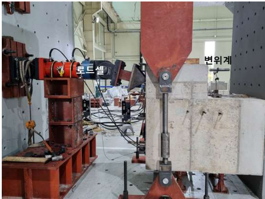
[그림 2.7] SP 보강재가 적용된 브라켓의 시험 셋팅 상세
