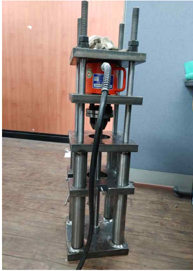
[Type I - SP 보강재 프리스트레스 힘 도입 장치 시제품]
