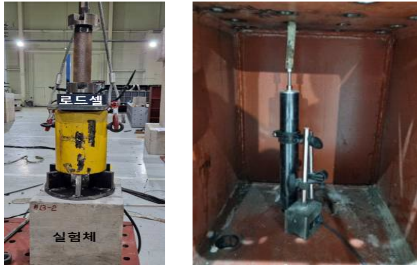
[그림 2.26] 직접인발 시험체 세팅 사세
