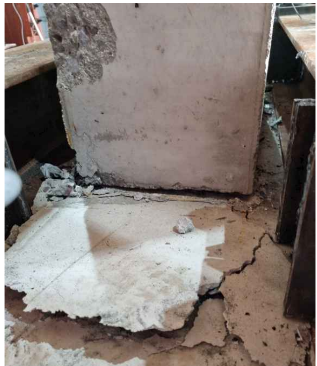
[그림 2.20] SP 보강재가 적용된 기둥의 파괴 모드
