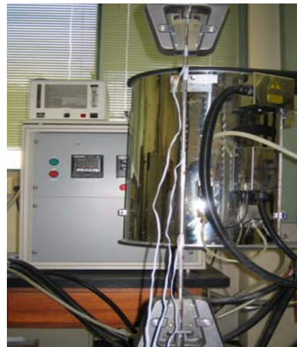
(d) U.T.M을 이용한 인장실험
