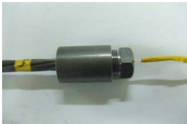
(e) 인장실험을 위한 정착구 설치
