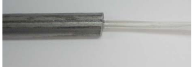
(b) 접착제를 이용한 광섬유센서 고정
