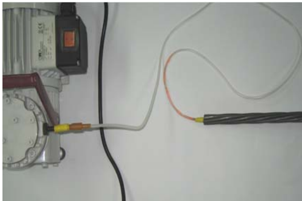
(b) 접착제 흡입을 위한 진공펌프 설치
