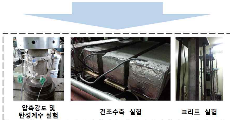
콘크리트 크리프 및 건조수축 실험 수행 예시
