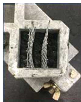
(c) 타설 및 Steel 전극 설치
