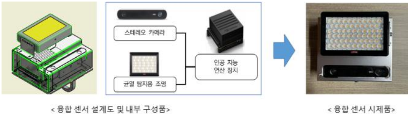
그림 2 융합 센서 시제품의 설계도와 구성품
