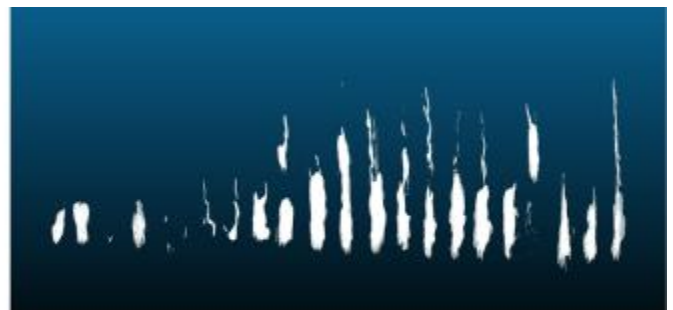
<콘크리트 손상의 3차원 형상 복원>
