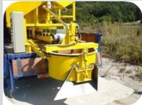
② 단일배합장치 설치↳
