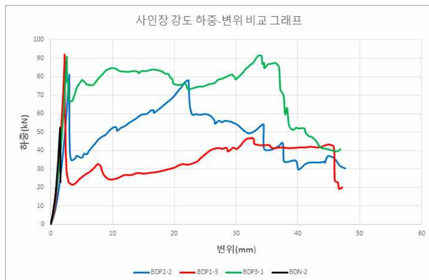
그림 2.20 배합별 사인장 강도 시험 하중-변위 그래프
