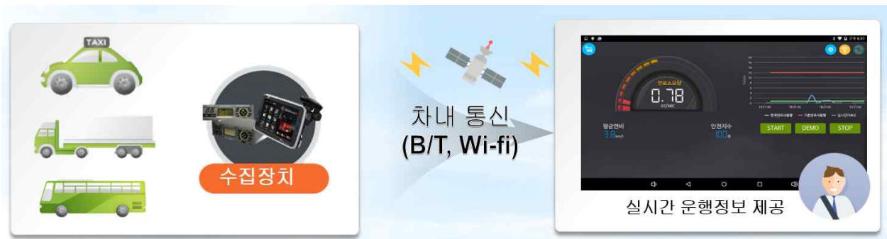
<그림 86> 차량단말기와 표시장치간 통신방식
