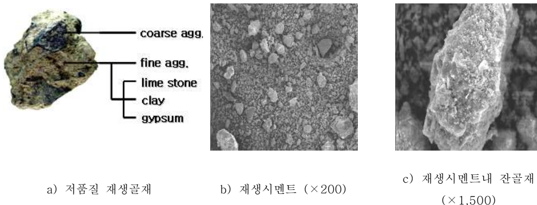
그림 1-3. 콘크리트 구성재료의 계면분리 문제로 인한 재생재료의 저품질화
