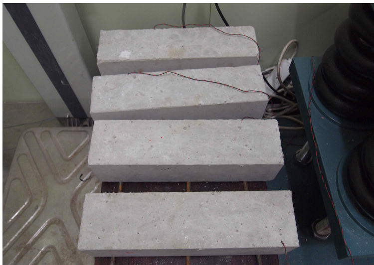
그림5-4. 매립형 스트레인 게이지로 측정되는 각형 시험체의 건조수축
