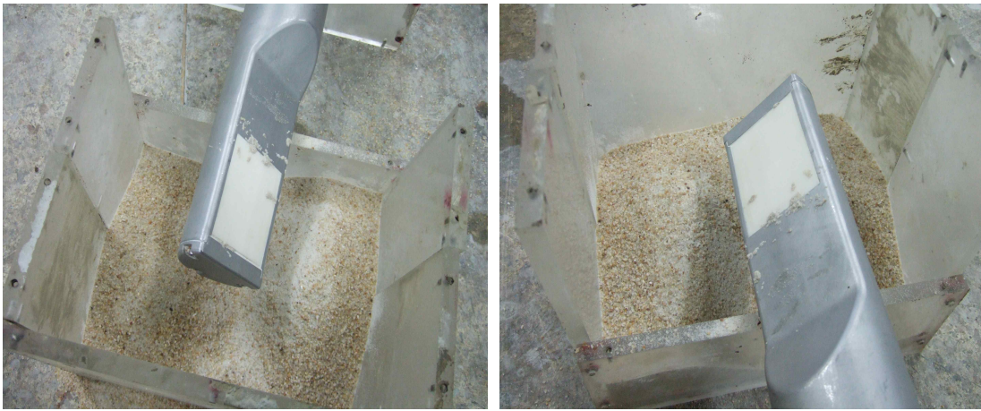
그림 3.4.20 Hydronix 센서를 이용한 골재의 수분 측정
