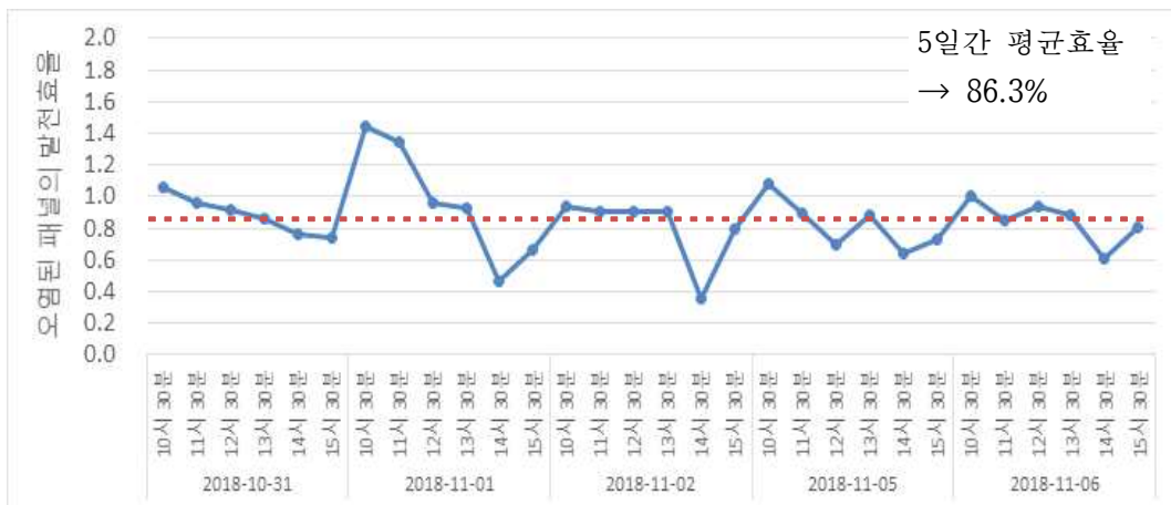
[그림 5] 비오염 패널 대비 오염 패널에서의 시간대 별 발전효율 (평균 86.3%)
