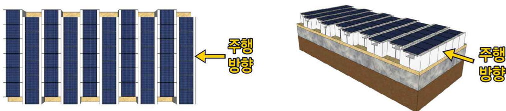
[그림 3] 태양광블록 시공패턴
