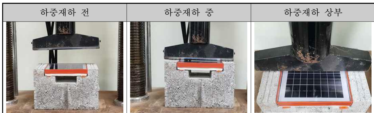
[표 9] 태양광 도로시스템 하중재하 시험전경
