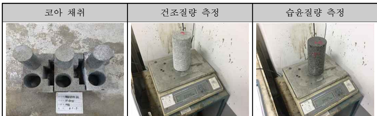
[표 5] 콘크리트 블록의 흡수율 시험
