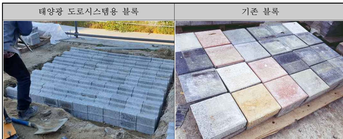
[표 1] 기존 블록과 태양광 도로시스템용 블록 형상 비교
